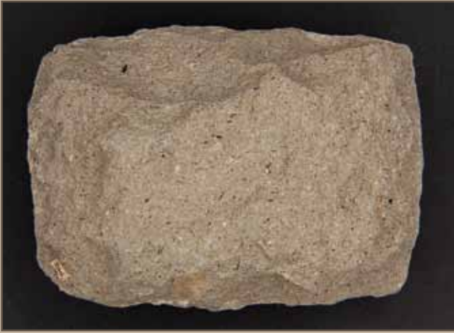
Zdj. 4: Ten jasnoszary andezyt jest stosunkowo spoisty. Oznacza to, że poszczególne minerały w skale są prawie niewidoczne: Skala pojawia się jako jednolita, drobna masa, przypominająca kaszkę.
