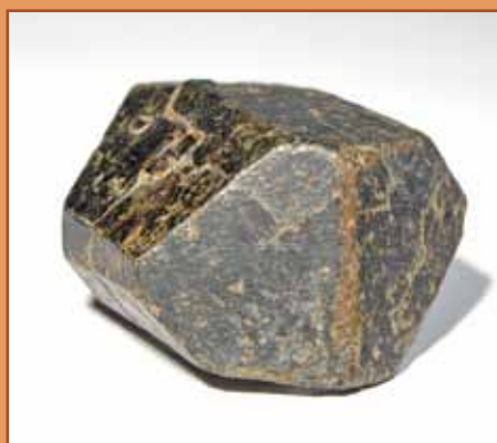
Zdj. 5: Ważną cechą charakterystyczną dla określenia minerału jest liczba ścian bocznych: Kryształ augitowy o typowym ośmiokątnym przekroju. ( Augit, Czeskie Góry Środkowe / Czechy; SNSD Mineralogy Inv. No. Min 16854 Sy (MMG); kryształ 1: dł./szer./gł.) = 2,5 x 2,1 x 0,7 cm)
