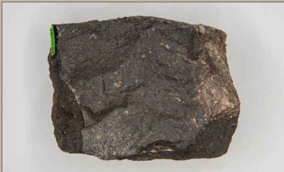
Zdj. 7: Ze względu na bardzo wysoką zawartość minerałów amfibolicznych (hornblenda), ten andezyt z Siedmiogórza ma bardzo ciemną, prawie czarną barwę. Wygląda bardzo podobnie do bazaltu, jak na przykład kolumny w Parku w Kromlau. (szerokość zdjęcia: 10 cm)
