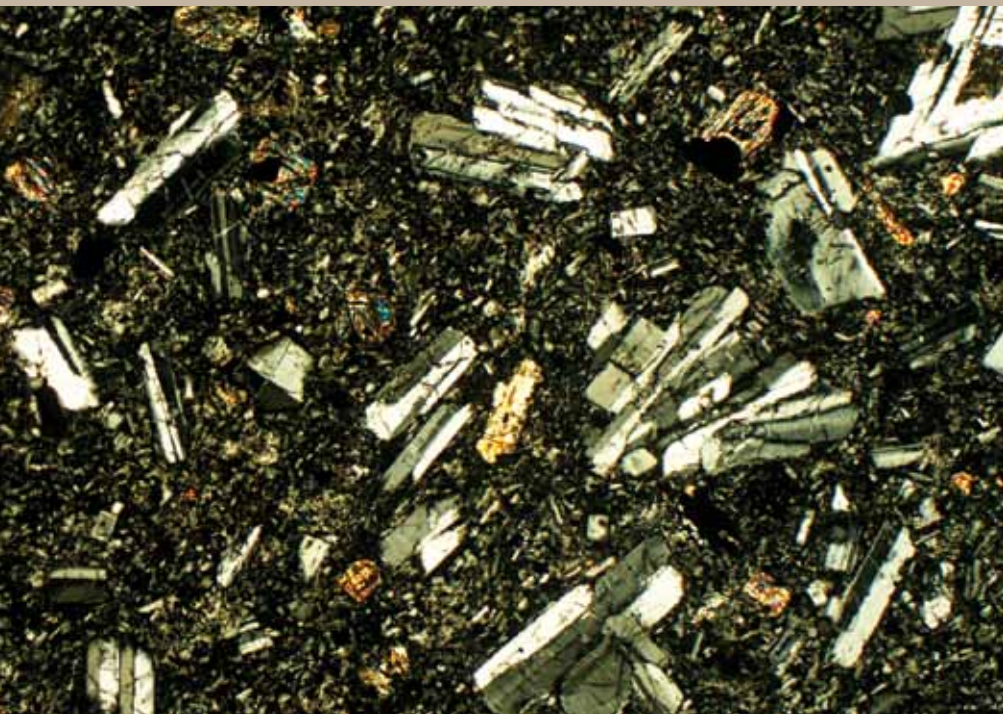
Zdj. 6: Pod mikroskopem ze światłem spolaryzowanym krzyżowo, porfirowa struktura skały andezytowej staje się bardzo wyraźna: większe kryształy unoszą się w delikatnej, ciemnej matrycy. Te kryształy nazywane są inkluzjami: jasne lub szare są fenokryształami minerału skalenia, brązowawe i opalizujące w kolorach tęczy są fenokryształami minerału miki. (szerokość zdjęcia: 3,4 mm)
