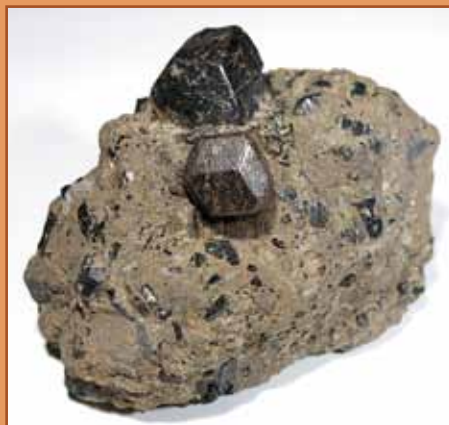
Zdj. 6: Duże kryształy hornblende w tej skale są krótkowzrostowe i mają trzy powierzchnie czołowe. (Kaersutit w tufie bazaltowym, Czeskie Góry Środkowe / Czechy; SNSD Mineralogia Inv. No. Min 16865 Sy (MMG); próbka: 6,5 \times 4,0 \times 3,5 cm, szerokość kryształów: górny 1,1 cm, dolny 0,9 cm)
