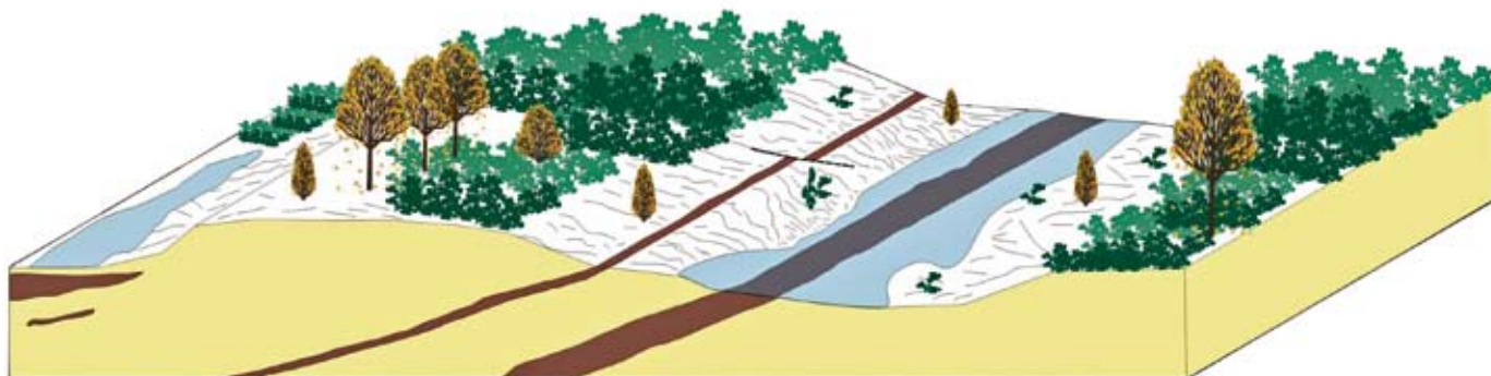
Blockbild des Kohleflözes Rysunek blokowy pokładu węgla Bloc diagram of the lignite seam
